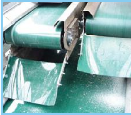
FRPZ - 6 Hammocks ในคอนเวเยอร์สำหรับลำเลียงแก้ว
