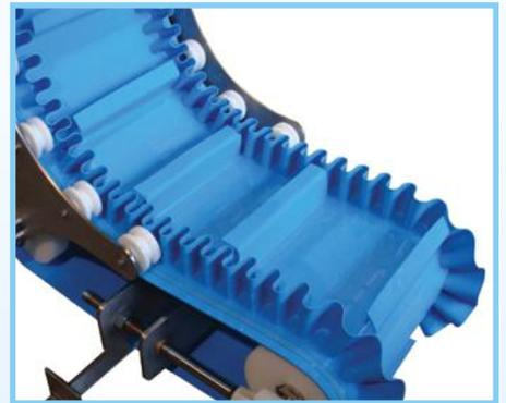
Banda SuperDrive™ elevadora con separadores, guías y paredes laterales
