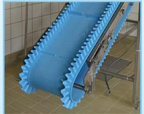
Banda SuperDrive™ con paredes y separadores laterales
