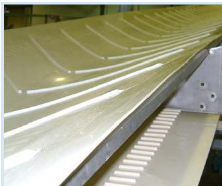
Banda cóncava SuperDrive™ con separadores en V
