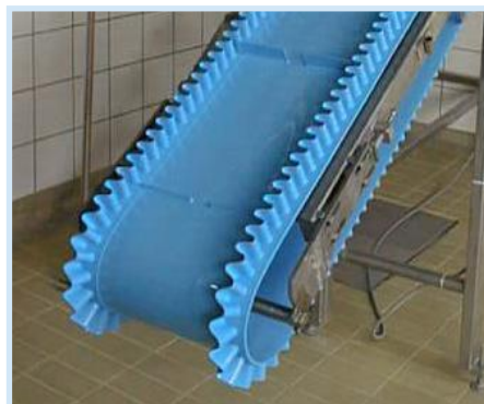
Banda SuperDrive™ con paredes y separadores laterales
